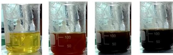
**Gambar 1.** Tahap perubahan warna pembentukan nanopartikel Fe<sub>3</sub>O<sub>4</sub> (a) kuning, (b) merah bata, (c) coklat, (d) hitam
